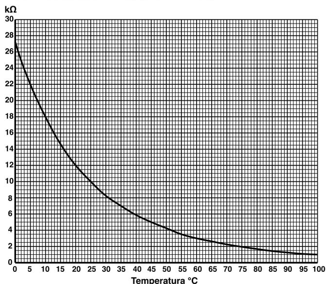
**NB: Diagramma valido solo per comandi a distanza con sensore di temperatura incorporato; (mod. CDB 100 / 200).**
